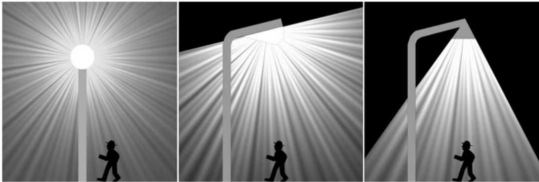
Abbildung 12: Leuchtradien bei Straßenbeleuchtung
